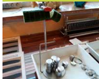
Figur 4. 'Agurk' der er testet for grad af sammenvoksning i en snitflade, umiddelbart efter at snitfladen er bristet, med en vægtskål med lodder nedenunder.
